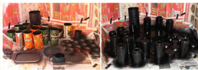
Hay que tapar cualquier rendija por la que puedan entrar la luz, como la abertura de la anilla y sobre todo la junta entre las dos partes del bote a montar. Yo lo hice con cinta adhesiva de aluminio, reforzado todo con cinta americana negra.
